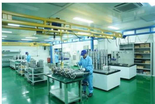
Montaža glavnog vretena: čista prostorija, kontrolisana temperatura i vlažnost
