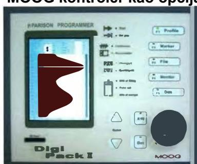
Precizna kontrola debljine creva: izbor između **B & R kontrolera** u standardnoj izvedbi (Austrija) ili **MOOG kontrolera** (Japan) kao opcije
