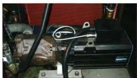
**Servo pogon za uštedu energije** - HAITIAN Hilectro servo motor i Sumitomo pumpa
