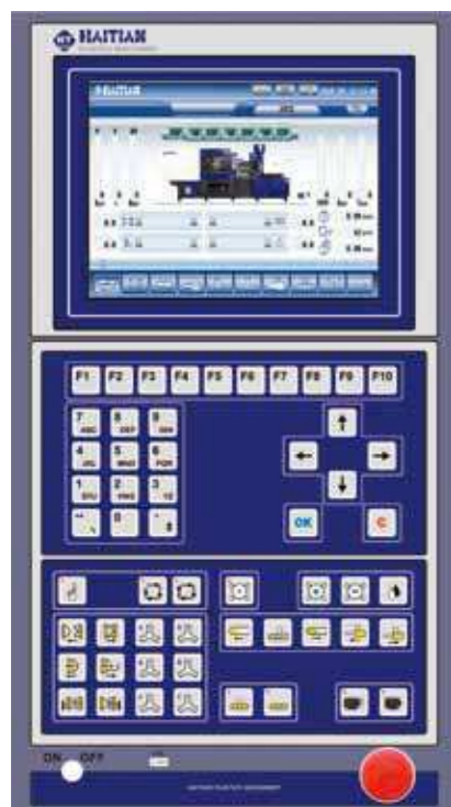
LCD touch-screen ekran visoke rezolucije od 10" ili 12" za olakšano upravljanje mašinom.
